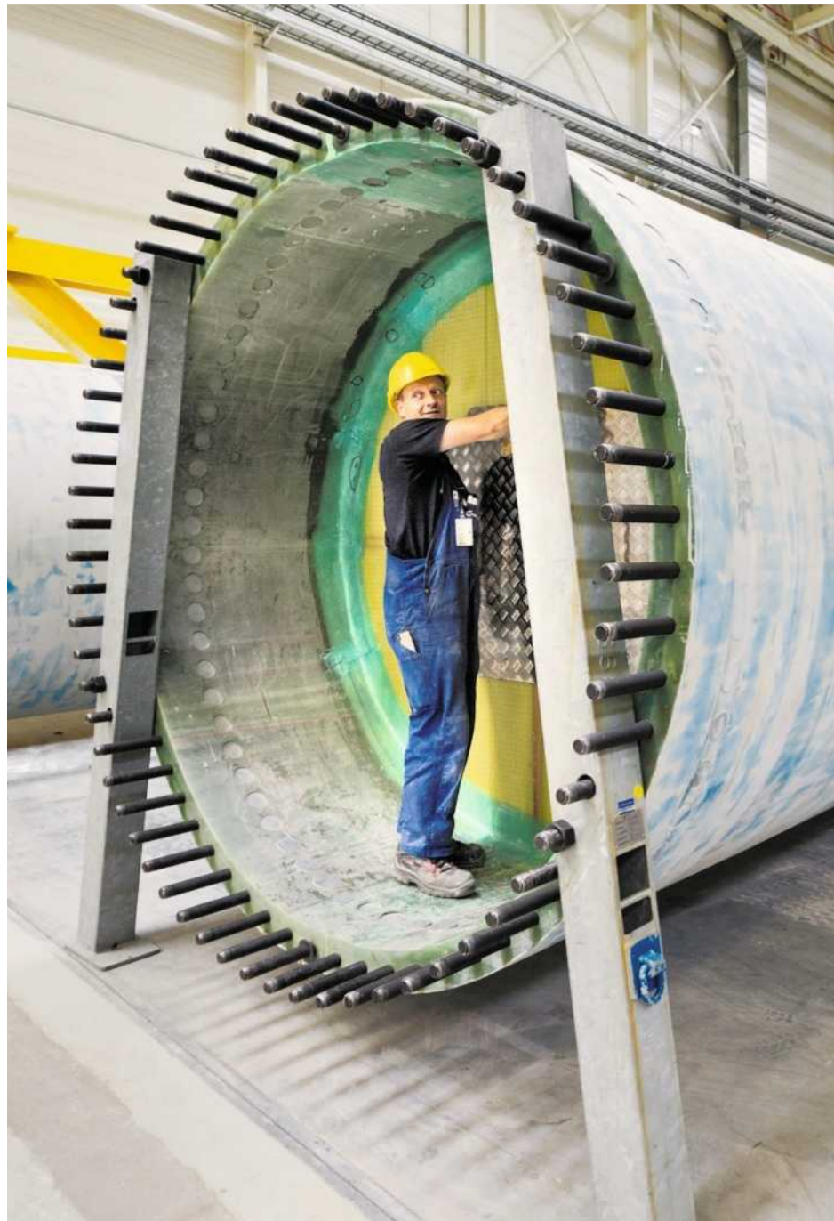
Produktion von Rotorblättern für Windanlagen bei Nordex in Rostock
